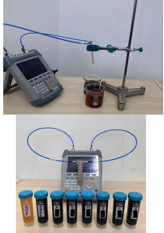
Şekil 4: Önerilen ölçüm sistemi ve farklı kullanım değerlerine sahip motor yağları
